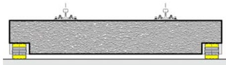
Rys. 4. Wibroizolatory typu KY przy bezpodsypkowej nawierzchni szynowej
