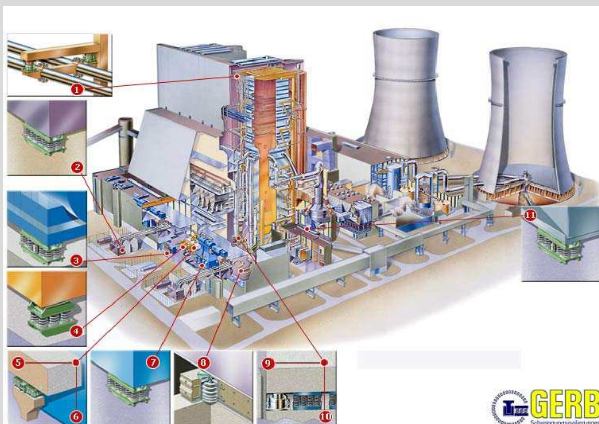
Rys.14. Wibroizolacja wyposażenia elektrowni
