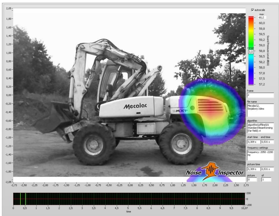
Rys.2. Praca jałowa – 1700 obr/min, odległość: 5 m, lewa strona, zakres częstotliwości: 2050 – 2200 Hz
