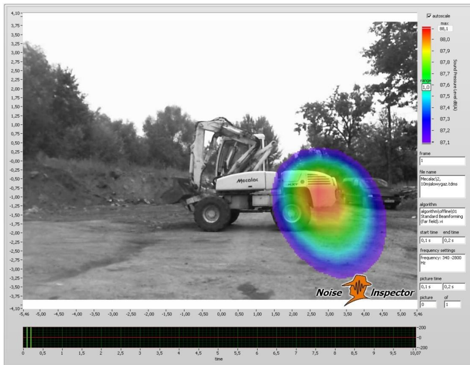
Rys.5. Praca łałowa – 2150 obr/min, odległość: 10 m, lewa strona, zakres częstotliwości: 340-2800 Hz
