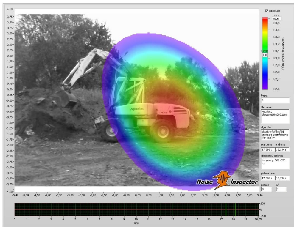
Rys.7. Przerzucanie ziemi, odległość: 10 m, lewa strona, zakres częstotliwości: 500 – 850 Hz
