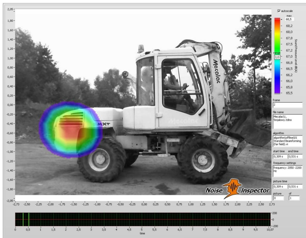
Rys.1. Praca jałowa – 1700 obr/min, odległość: 5 m, prawa strona, zakres częstotliwości: 2050 – 2200 Hz.
