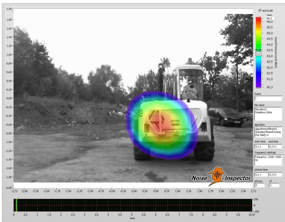
Rys.3. Praca jałowa – 1700 obr/min, odległość: 5 m, tył, zakres częstotliwości: 2200 – 2400 Hz
