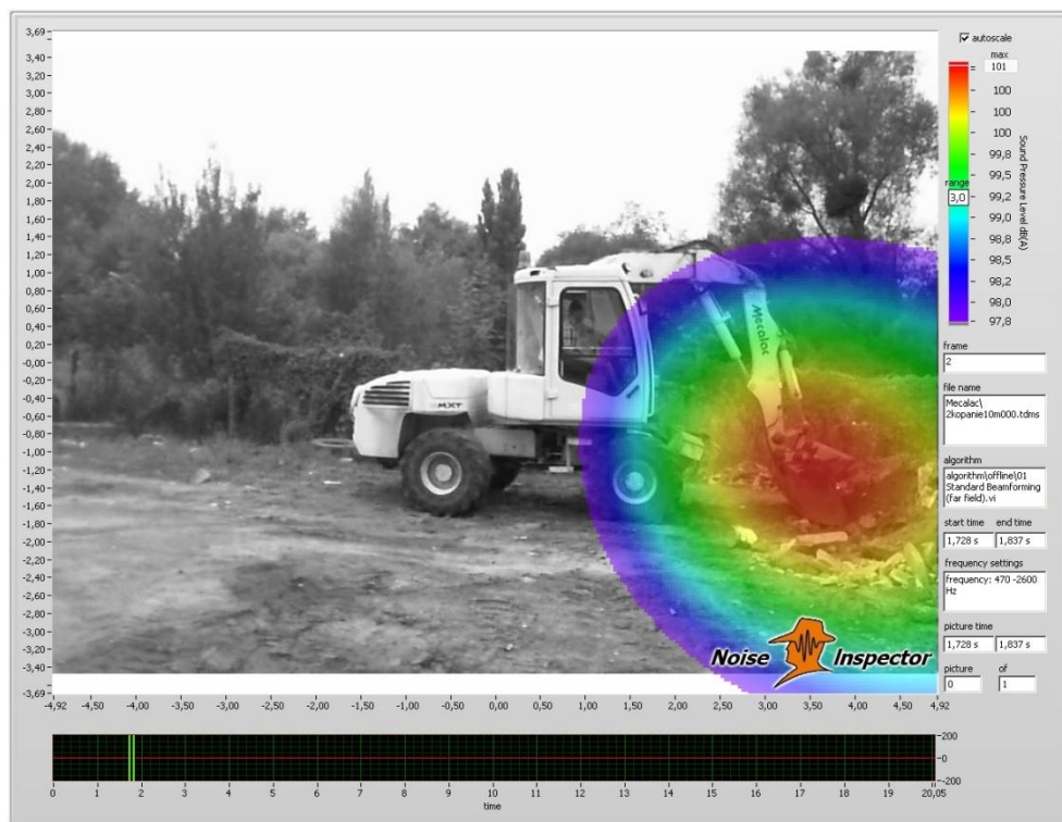
Rys.8. Przerzucanie ziemi, odległość: 10 m, prawa strona, zakres częstotliwości: 470 – 2600 Hz
