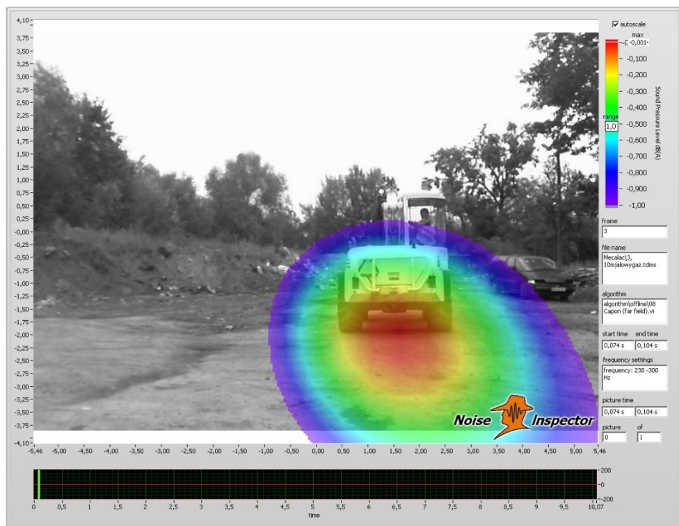
Rys.6. Praca jałowa – 2150 obr/min, odległość: 10 m, tył, zakres częstotliwości: 230-300 Hz
