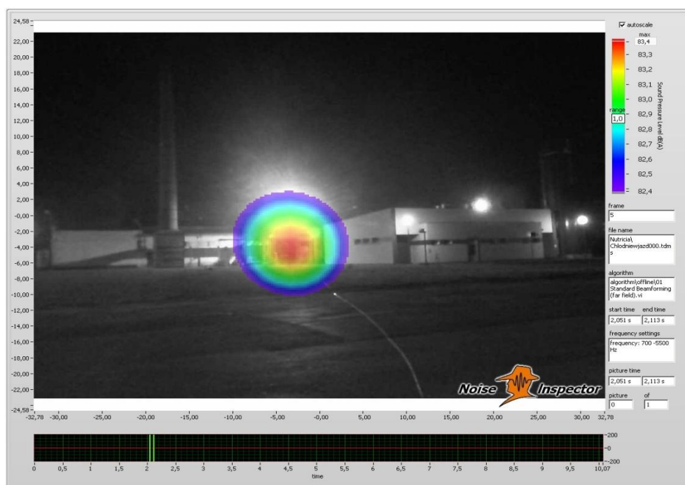
Rys.11. Chłodnia wentylatorowa, odległość:60 m , zakres częstotliwości: 700-5500 Hz
