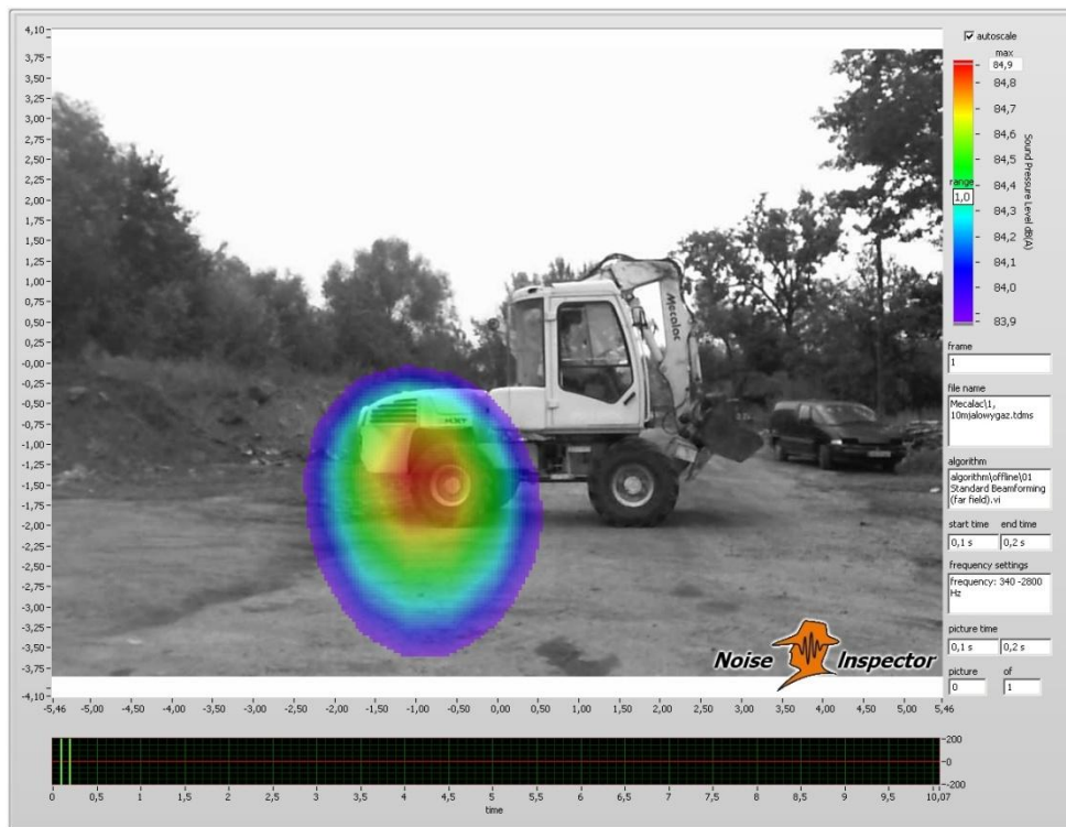
Rys.4. Praca łałowa – 2150 obr/min, odległość: 10 m, prawa strona, zakres częstotliwości: 340-2800 Hz
